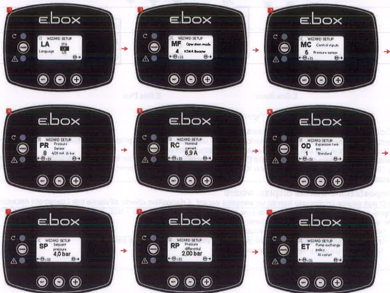
Figura 48: Pressurizzazione KIWA con sensore di pressione
