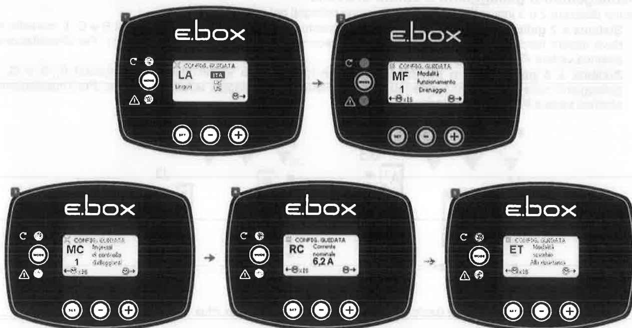
Figura 36: Configurazione Drenaggio galleggianti o sonde di livello
