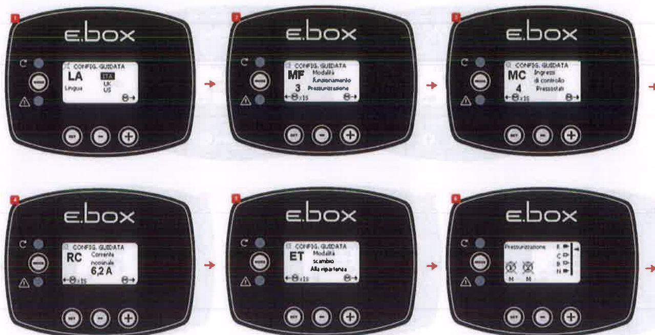
Figura 13: Configurazione con Pressostati
