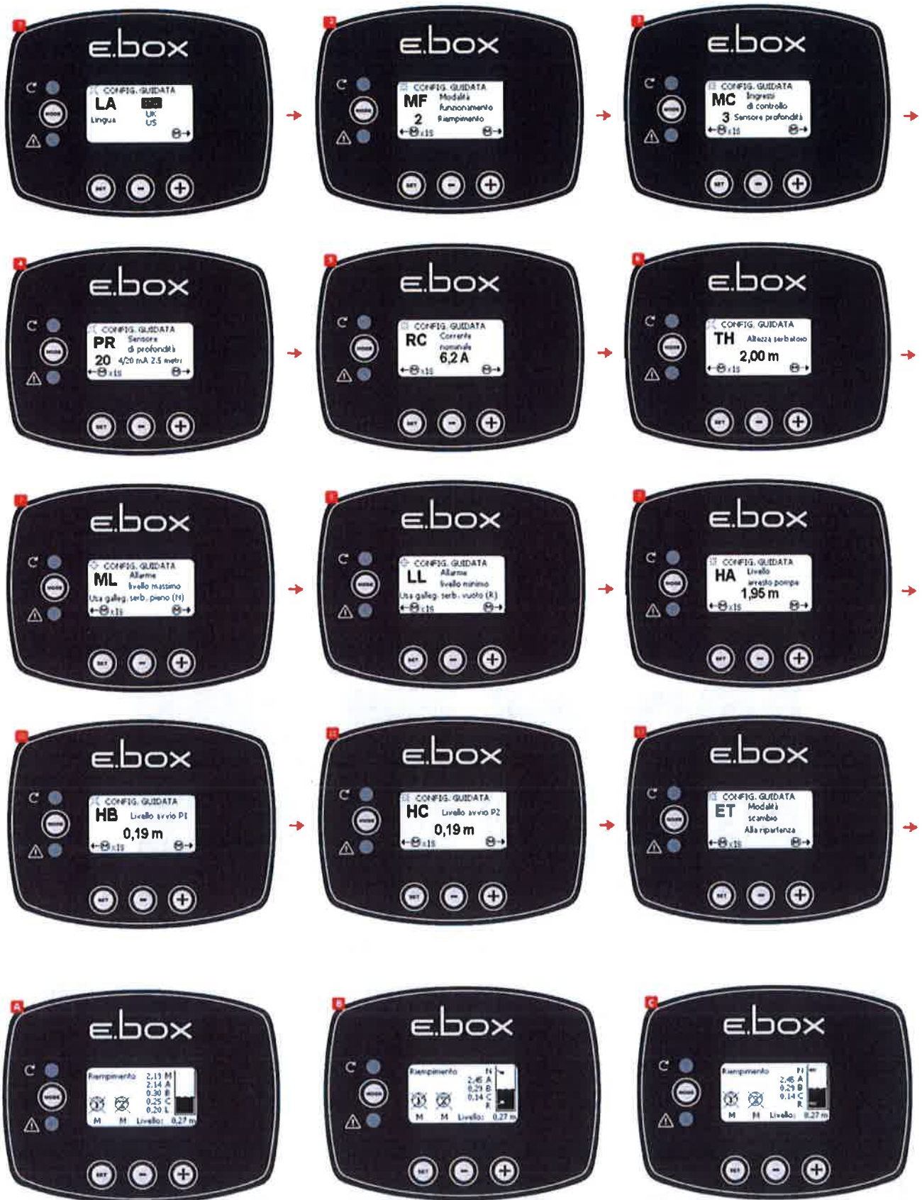
Figura 26: A Stato del sistema con solo sensore di profondità, B sensore di profondità e galleggianti, C sensore di profondità e sonde di livello
