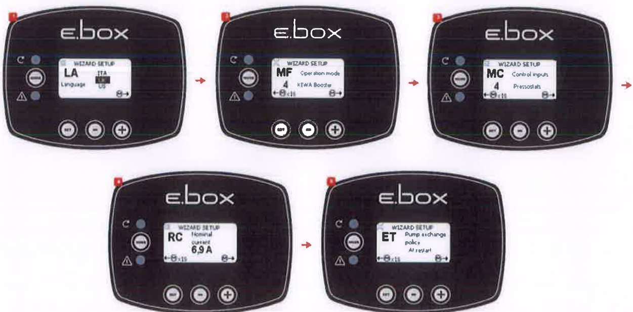
Figura 49: Configurazione Kiwa con Pressostati
